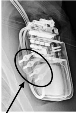
Pin di connessione delle estensioni (4) e porte di connessione dell'adattatore per tasca (4)
