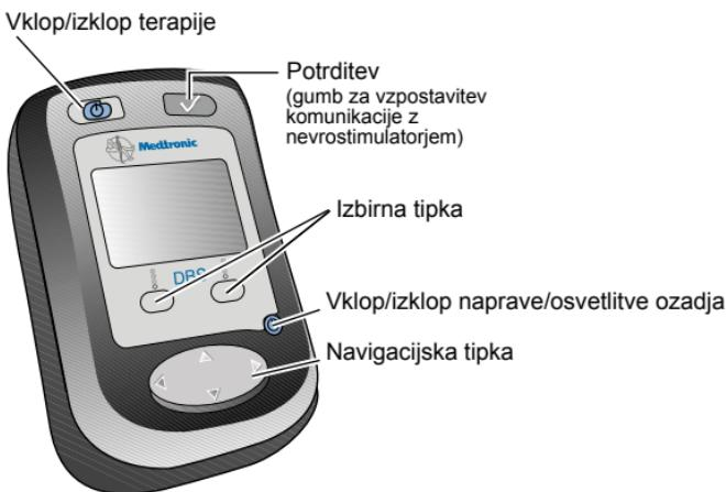
**Slika 2.2** Tipke za upravljanje bolnikovega programatorja.
