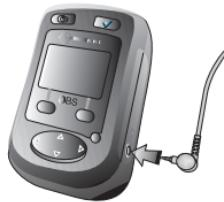
**Slika 2.23** Vtikač antene vstavite v priključek za anteno.
