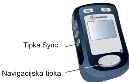
Slika 6.1 Lokacija tipke za sinhronizacijo ( Sync ) in Navigacijske tipke.
