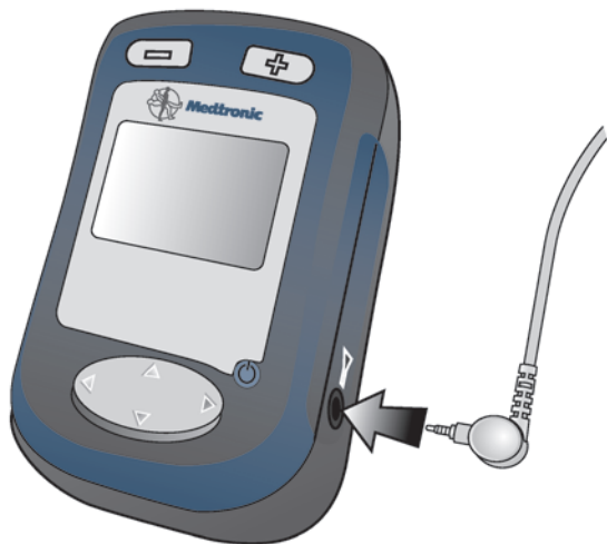
Slika 4.20 Vstavite vtičač antene v vtičnico za anteno.
