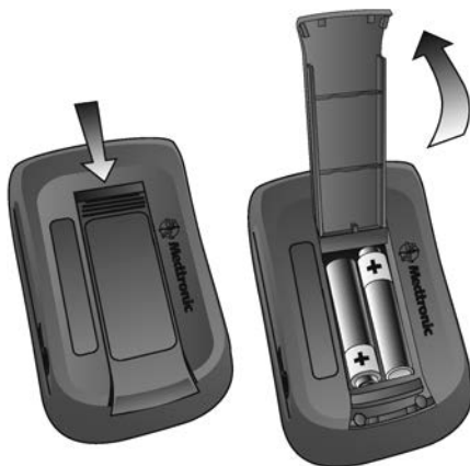
Slika 7.2 Odstranitev pokrova za baterije.
