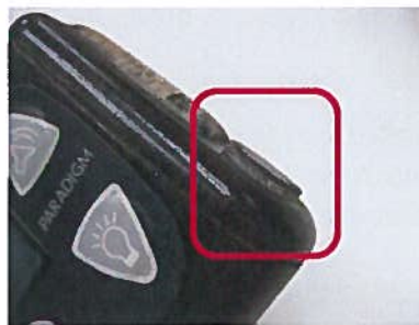
Razrahljan poklop na ohišju pogona črpalke -
